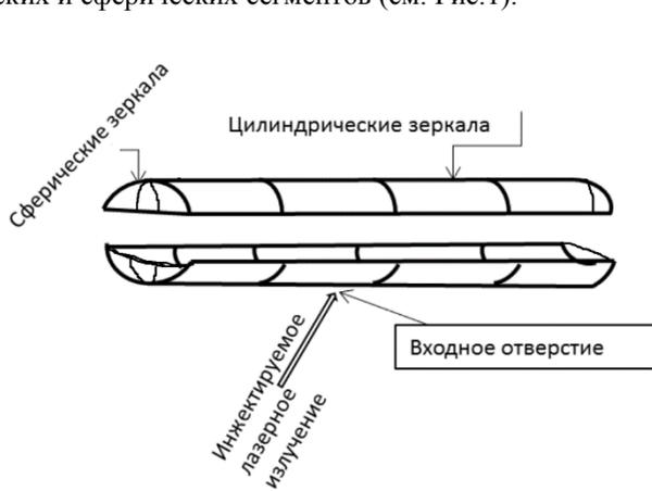
Рис. 1. Принципиальная схема системы вогнутых зеркал
